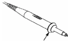
Рис. 7-6 Защитный упор (по стрелке)
